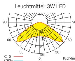
Lampenlichtstrom Not (DC) / Netz: 280lm/120lm – **Nennbetriebsdauer: 3h**
