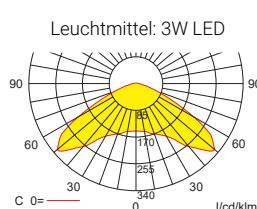
Lampenlichtstrom Not (DC) / Netz: 120lm/120lm – **Nennbetriebsdauer: 8h**
