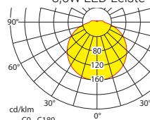
Lampenlichtstrom Not (DC) / Netz: 330lm/1160lm – **Nennbetriebsdauer: 8h**
