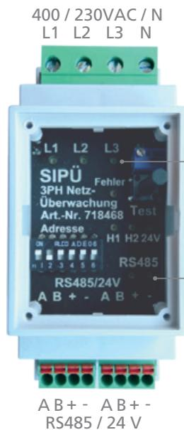
3 grüne LEDs zeigen die ordnungsgemäße Spannung an L1-L3 an. Eine rote LED zeigt einen Phasenausfall an.
