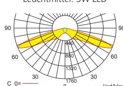
Lampenlichtstrom Not/Netz: 190lm/190lm – Nennbetriebsdauer: 1h/3h
