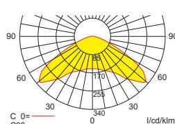
Lampenlichtstrom Not/Netz: 190lm/190lm – Nennbetriebsdauer: 1h/3h
