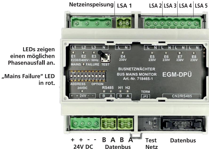
**Funktionsweise** Dieser Busnetzwächter ist systemgebunden und kommuniziert auf direktem Weg mit Anlagen der BUSINESS-Serie. Er ist mit einer Sicherheitsfunktion ausgestattet: Die Kommunikationsüberwachung reagiert auf **Leitungsunterbrechung oder Kurzschluss**; bei Kommunikationsfehlern wird eine Störung gemeldet.
