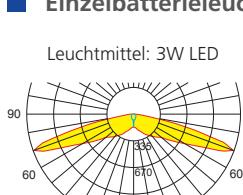
Lampenlichtstrom Not/Netz: 280lm/120lm – Nennbetriebsdauer: 1h/3h
