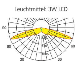
Lampenlichtstrom Not/Netz: 120lm/120lm – Nennbetriebsdauer: 8h
