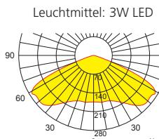
Lampenlichtstrom Not/Netz: 280lm/120lm – Nennbetriebsdauer: 1h/3h
