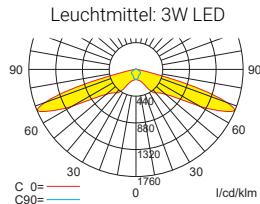
Lampenlichtstrom Not (DC) / Netz: 280lm/120lm – **Nennbetriebsdauer: 3h**
