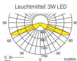
Lampenlichtstrom Not (DC) / Netz: 120lm/120lm – **Nennbetriebsdauer: 8h**
