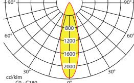
Lampenlichtstrom Not (DC) / Netz: 480lm/360lm – **Nennbetriebsdauer: 1h**
