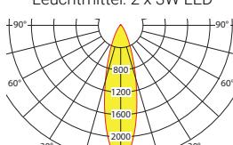
Lampenlichtstrom Not (DC) / Netz: 240lm/360lm – **Nennbetriebsdauer: 8h**
