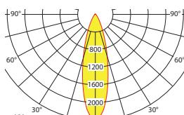
Lampenlichtstrom Not (DC) / Netz: 480lm/360lm – **Nennbetriebsdauer: 3h**
