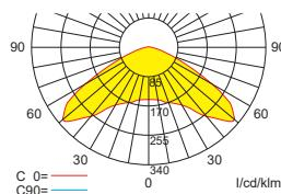
Lampenlichtstrom Not (DC) / Netz: 280lm/120lm – Nennbetriebsdauer: 1h
