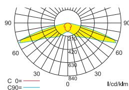
Lampenlichtstrom Not (DC) / Netz: 240lm/240lm – Nennbetriebsdauer: 1h
