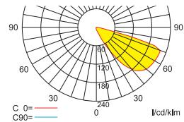
Lampenlichtstrom Not/Netz: 120lm/120lm – Nennbetriebsdauer: 1h/3h/8h
