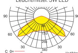
Lampenlichtstrom Not (DC) / Netz: 120lm / 50lm – **Nennbetriebsdauer: 8h**
