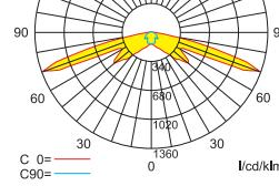
Lampenlichtstrom Not/Netz: 480lm/360lm – Nennbetriebsdauer: 1h/3h
