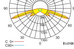
Lampenlichtstrom Not/Netz: 240lm/360lm – Nennbetriebsdauer: 8h
