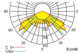
Lampenlichtstrom Not/Netz: 480lm/360lm – Nennbetriebsdauer: 1h/3h
