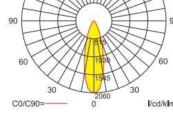
Lampenlichtstrom Not/Netz: 480lm/360lm – Nennbetriebsdauer: 1h/3h
