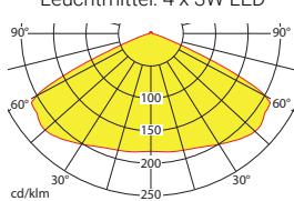
Lampenlichtstrom Not (DC) / Netz: 320lm/960lm – **Nennbetriebsdauer: 8h**
