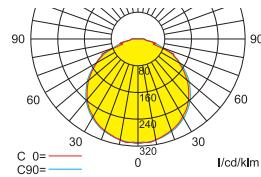
Lampenlichtstrom Not (DC) / Netz: 380lm/380lm – **Nennbetriebsdauer: 1h**
