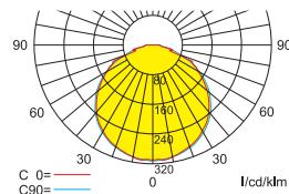
Lampenlichtstrom Not (DC) / Netz: 320lm/380lm – **Nennbetriebsdauer: 3h**
