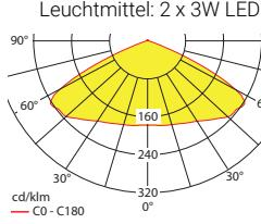
Lampenlichtstrom Not (DC) / Netz: 480lm/360lm – **Nennbetriebsdauer: 3h**
