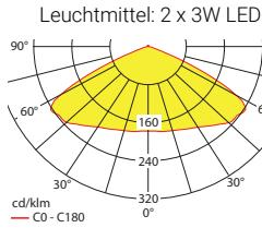
Lampenlichtstrom Not (DC) / Netz: 480lm/360lm – **Nennbetriebsdauer: 1h**
