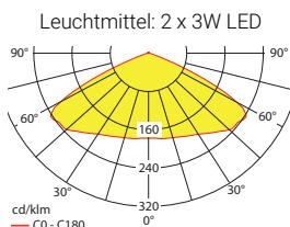
Lampenlichtstrom Not (DC) / Netz: 240lm/360lm – **Nennbetriebsdauer: 8h**
