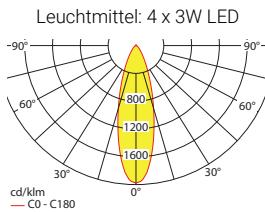
Lampenlichtstrom Not (DC) / Netz: 580lm/960lm – **Nennbetriebsdauer: 1h**
