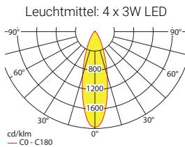
Lampenlichtstrom Not (DC) / Netz: 320lm/960lm – **Nennbetriebsdauer: 8h**
