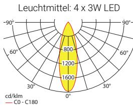
Lampenlichtstrom Not (DC) / Netz: 580lm/960lm – **Nennbetriebsdauer: 3h**
