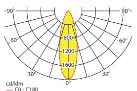
Lampenlichtstrom Not (DC) / Netz: 580lm/960lm – **Nennbetriebsdauer: 1h**
