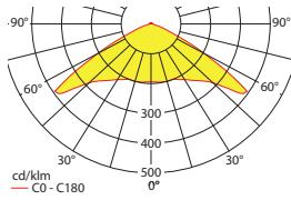
Lampenlichtstrom Not (DC) / Netz: 280lm/120lm – **Nennbetriebsdauer: 3h**
