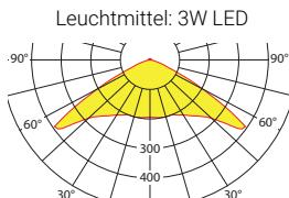
Lampenlichtstrom Not (DC) / Netz: 120lm/120lm – **Nennbetriebsdauer: 8h**
